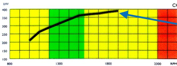
La puissance (KW/CV) en fonction du régime du moteur
